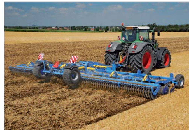
Ideální pro rychlou strnišťovou podmiťku, zapravení výdrolu je Softer Foto archiv firmy
