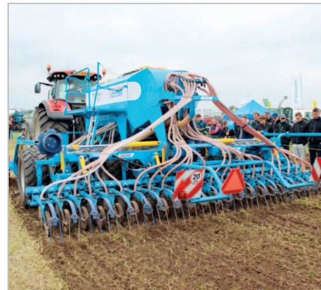
Secí stroj Falcon Strip předvádí pásové zpracování půdy a setí
