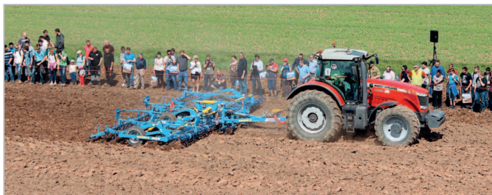
Předsetový kombinátor Verso při rychlosti 10 až 15 km/h prokypřuje pozemek, rozdrobí hroudy a urovnává povrch pole. Foto Jiří Hruška
