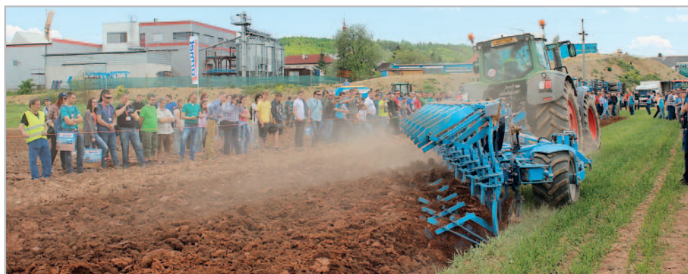
Semiradličkový pluh Vidium P 350 Vario s prutovými odhrnovačkami a předradličkami pro lepší zaklápění rostlinných zbytků. Foto Jiří Hruška
