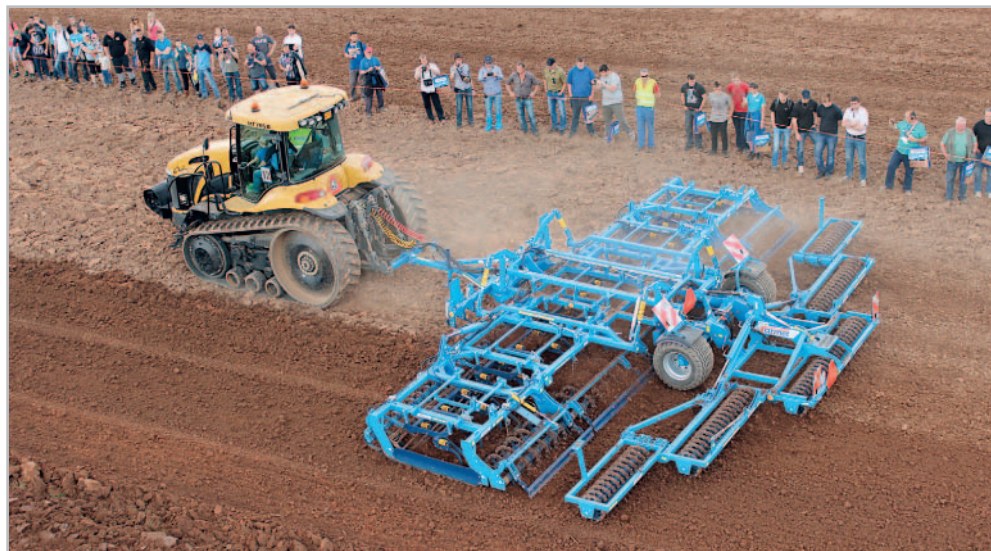
Předsetový kombinátor Kompaktomat prokypřuje, urovnává a zpětně utužuje půdu a vytváří setové lůžko. Foto Jiří Hruška
