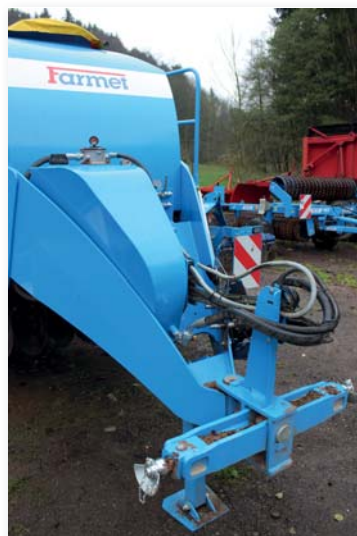
► Traktory se slabší hydraulickou soustavou si vyžádaly samostatnou olejovou nádrž. Ventilátor je poháněn přes hydromotor pomocí vývodového hřídele
