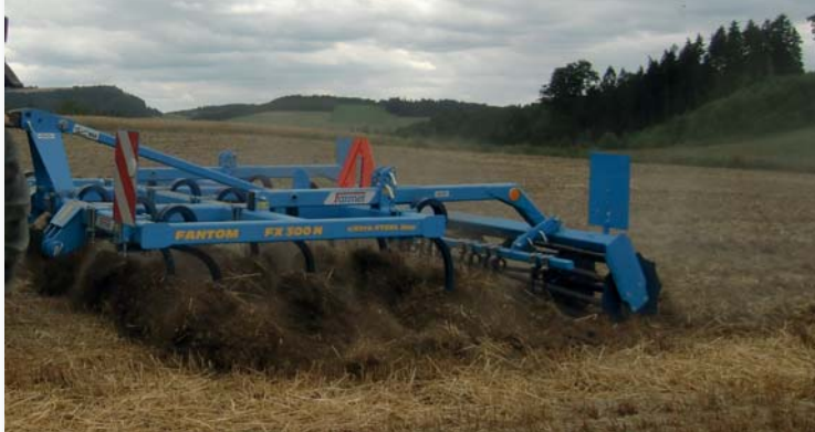
▶ Třířadý radličkový kyprič Fantom 300 N je určen převážně pro podmítku, ale umí nahradit i pluh
