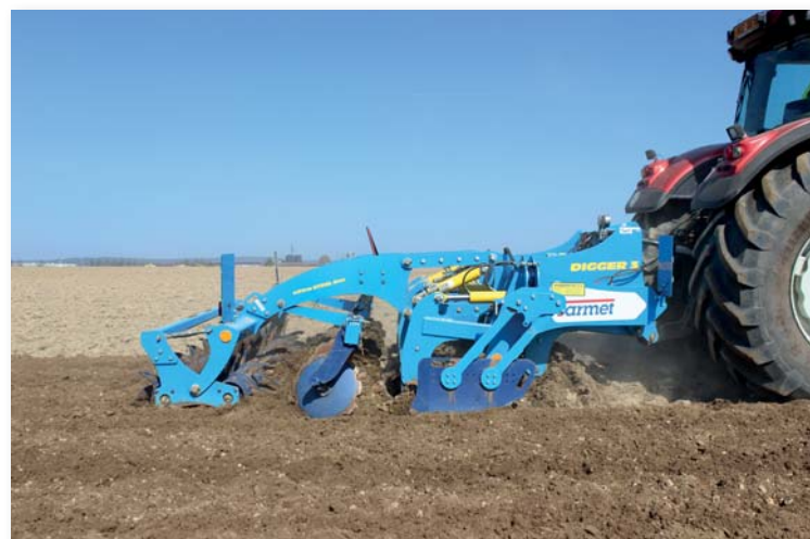
► Hlubkový kypřič Digger 3 není jen prostý podrývák. Je to speciální stroj, který hlubkově prokypřil nepropustnou podorniční vrstvu i vlastní ornici, zapraví rostlinné zbytky a upraví povrch pole
