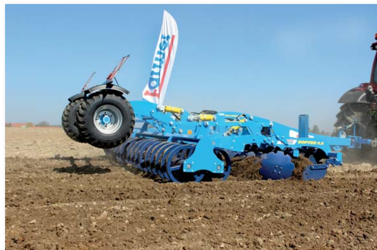
► Pořadatel předvedl tři diskové podmítače Softer, každý s jiným válcem. Na snímku je Softer 4,5 PS s double ring válcem pro střední utužení půdy
