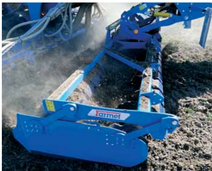
Tanierovú sekciu možno vyzdvihnúť, či úplne odpojiť, prípadne nahradiť ďalšími typmi náradia.
