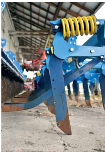
Strip-Tillová sekcia (vľavo) a pôdoobrábacia sekcia pre jarné výsevy.
