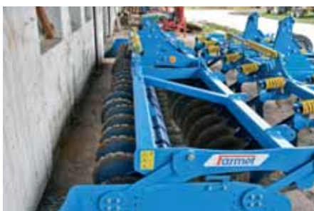
Odstavená tanierová sekcia. Dva a dva nastaviteľné taniere slúžia ako kypriče stôp traktora.
