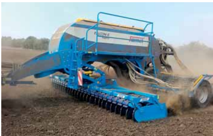
Obslužná plošina sa nachádza po celej dĺžke zásobníka. Dostatočne veľký plniaci otvor chráni pred prachom rolovacia plachta.
