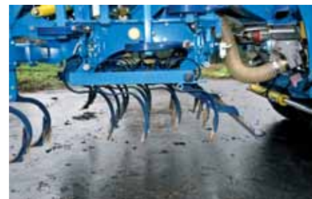
Strip-Tillová sekcia (vľavo) a pôdoobrábacia sekcia pre jarné výsevy.
