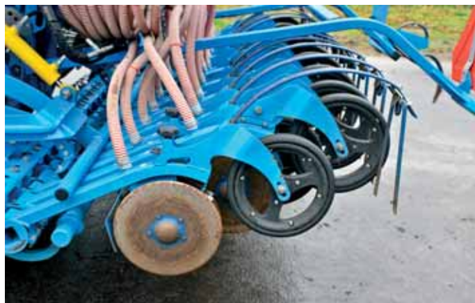
Detailný záber dvojkotúčových výsevných pätiiek s utlačovacím koleskom.
