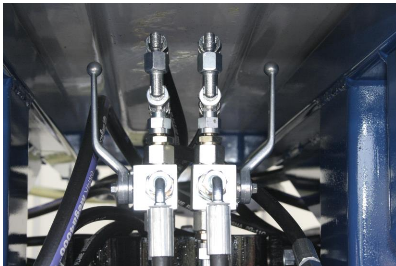
Obr. č. 3. Páky ovládacích ventilů v poloze pro rozklápění a sklápění stroje
