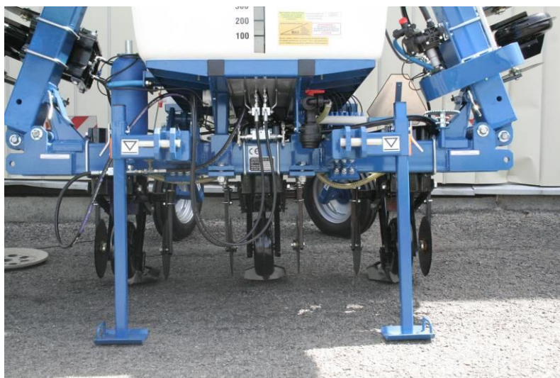
Obr. 2. Odstavné nohy stroje ve skladovací poloze
