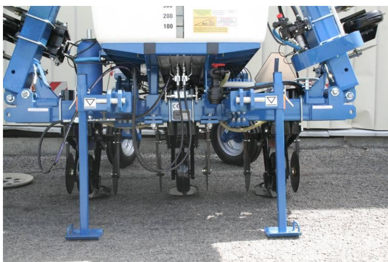
Obr. 8. Odstavné nohy stroje ve skladovací poloze
