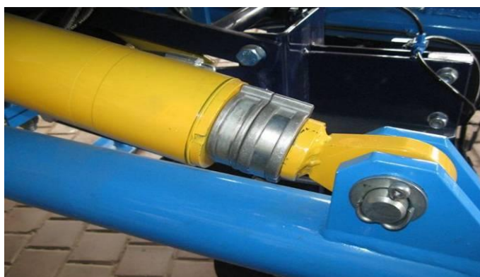
Obr. 12. Vymežovací podložky pístnic podvozku
