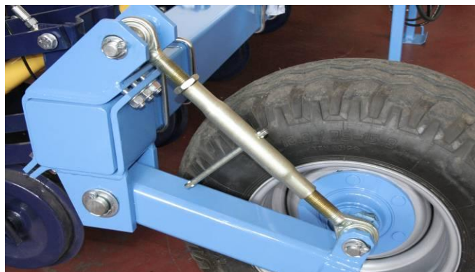
Obr.11. Stavěcí šroub předního pojezdového kola
