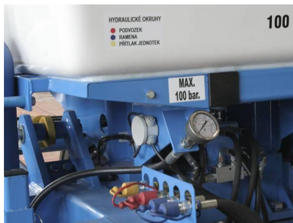
Obr. 7. Zapojení hydraulických okruhů
