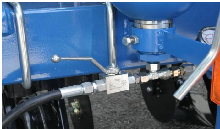
Obr. č. 13. Ventil hydraulického přitlaku v otevřené poloze
