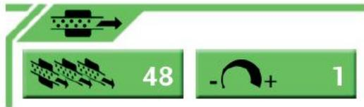
Dieses Anzeigefeld dient zur Einstellung der Anzahl der angeschlossenen Aussaatsensoren und deren Empfindlichkeit der Messung.
