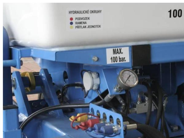
Abb. 7. Anschluss der Hydraulikkreisläufe
