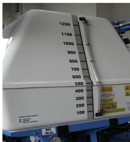
Abb. 1. Düngemitteltank mit Füllstandsanzeiger
