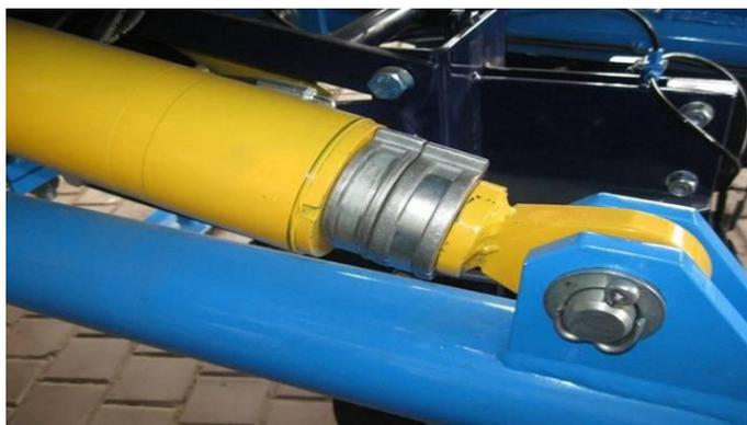
Abb. 12. Begrenzungsscheiben der Kolben des Untergestells
