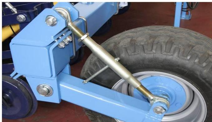
Abb. 11 Einstellschraube der vorderen Verfahrräder
