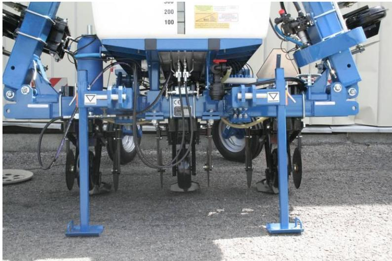
Abb. 8. AbstellfüÙe in der zusammengeklappten Position
