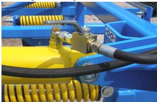
Abb.4 – Kugelventil Stellung **AUF**
