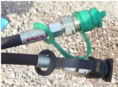
**SCHWARZE, GRÜNE STAUBDECKEL** – hydraulische Betätigung zur Einstellung der Scheibenhöhe
